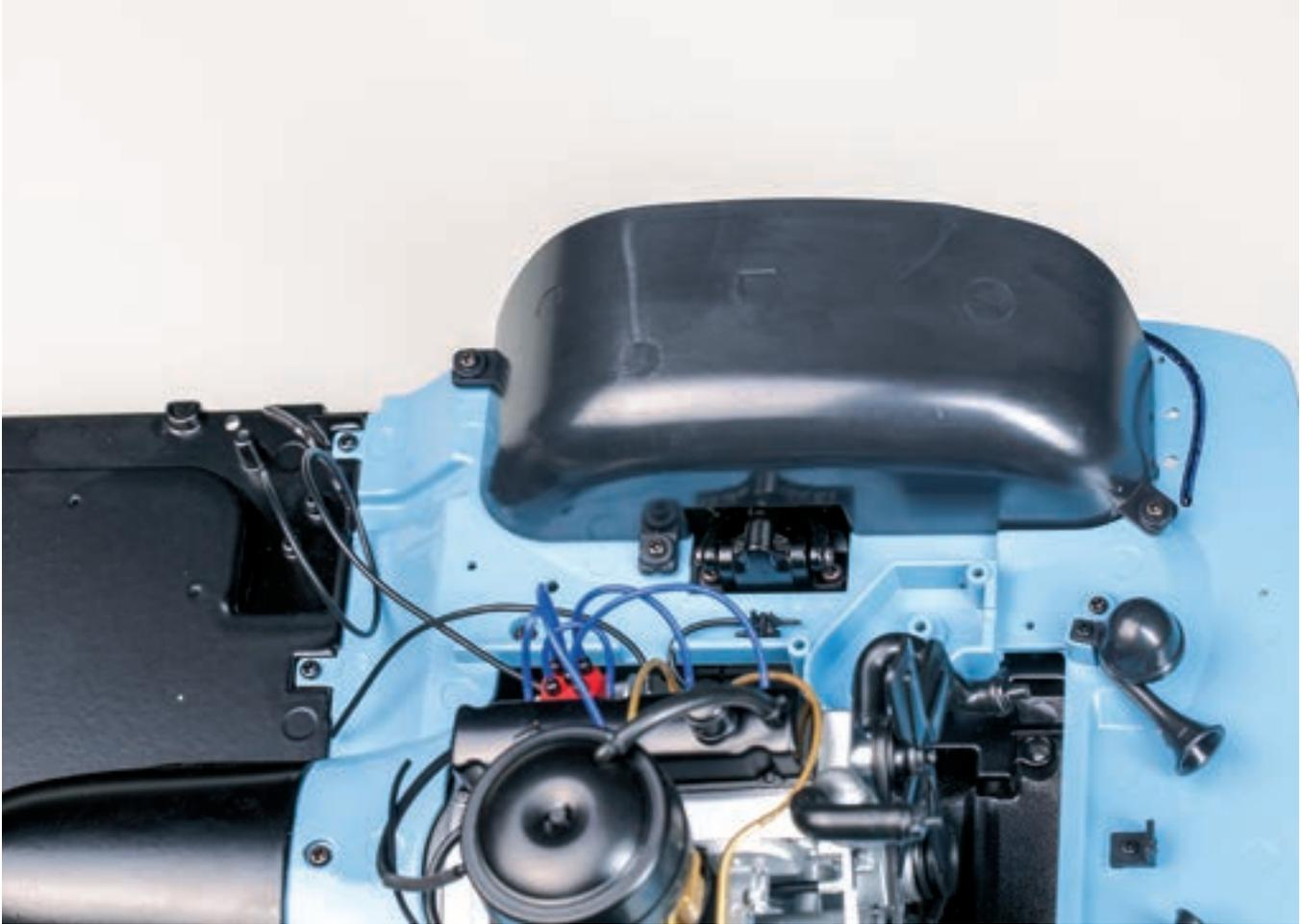
Поместите левый передний брызговик поверх переднего левого колеса. Совместите три крепежные проушины брызговика с ответными отверстиями на полу кузова модели, расположенными вокруг проема арки переднего колеса. Обратите внимание: вырез на внутренней боковой поверхности брызговика должен располагаться около переднего амортизатора и совпадать с вырезом в полу кузова. Для фиксации детали используйте три винта 2,0×4 (ВМ).
